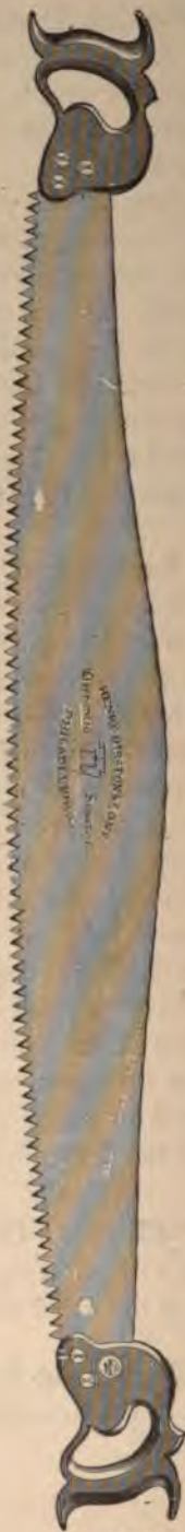
Fig. 297. Double Skew Taper Blade.
